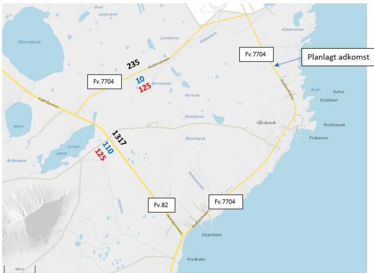
Figur 3-1. ÅDT fremskrevet til år 2046. Svarte tall er ÅDT 2046, røde tall er bidrag fra planområdet, blå tall er bidrag fra generell trafikkvekst 2019-2046. (Kartgrunnlag: NVDB 11 ).
