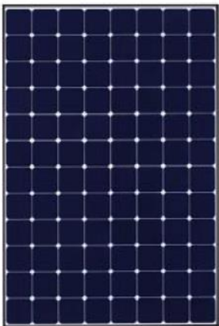
Figur 6. Solcellepanel av type SUNPOWER X21-335-BLK. 335 -345 Wp (1,6 x 1,05 m) –Monokrystallinsk. 21% virkningsgrad ved STD.
