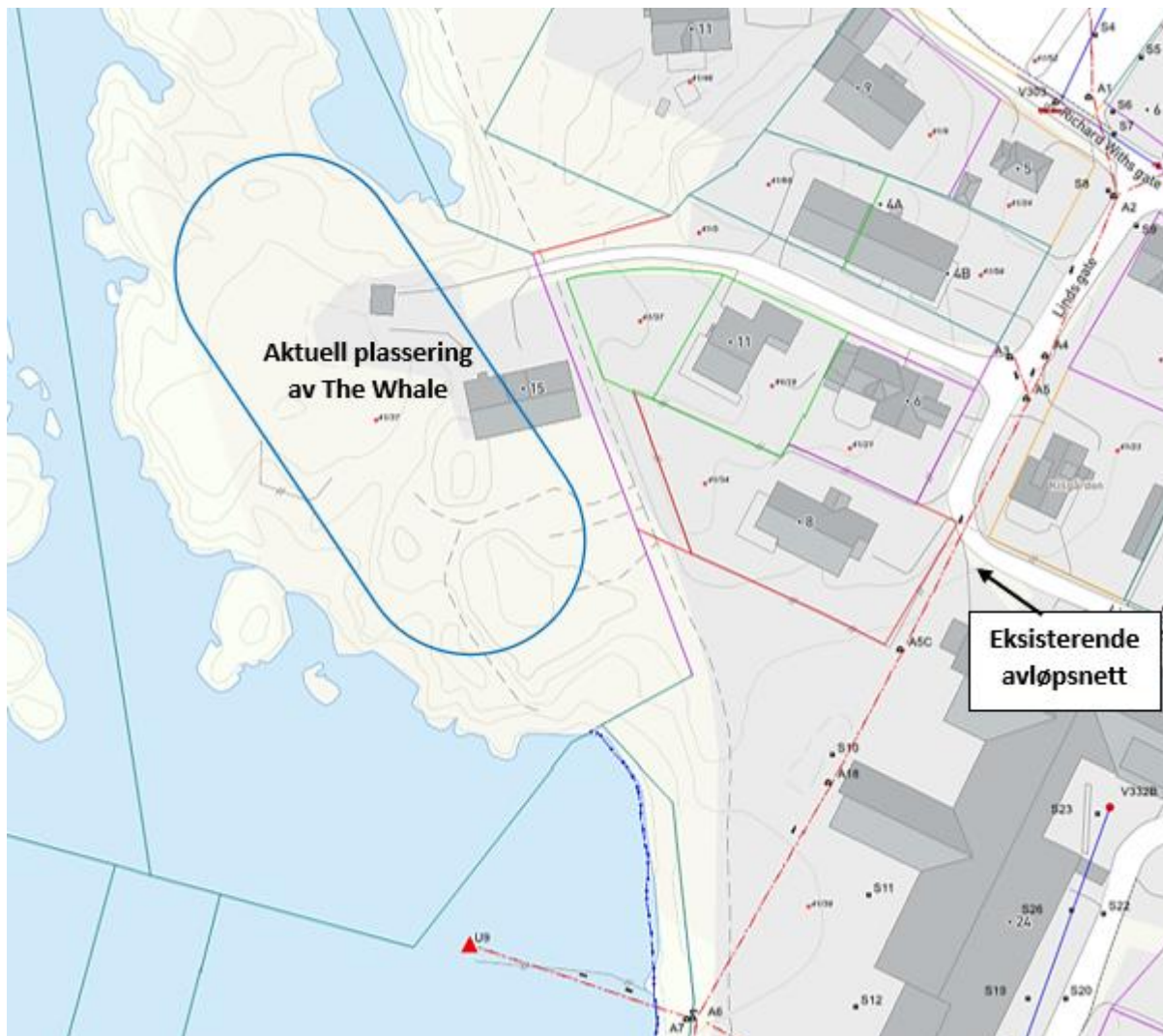
Figur 2: Viser planområdet for The Whale i forhold til det kommunale avløpsledningsnettet i Richard Withs gate og Linds gate.
